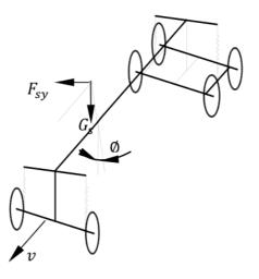
Fig. 5. Roll diagram
