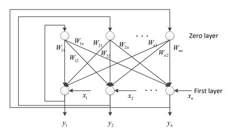
Fig. 3. Network structure of DHNN
