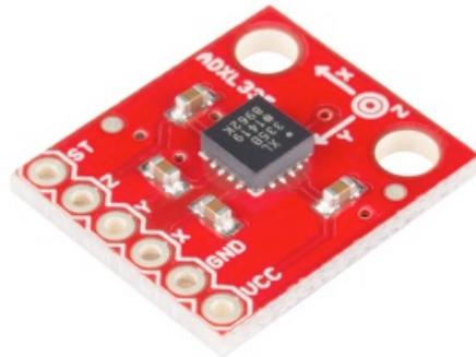
**Fig. 6.** SparkFun Triple Axis Accelerometer Breakout
