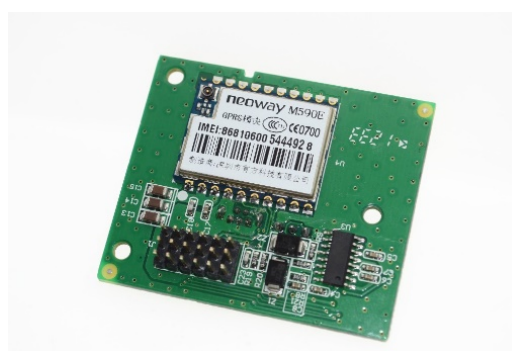
Fig. 7. GSM/GPRS module Neo_M590
