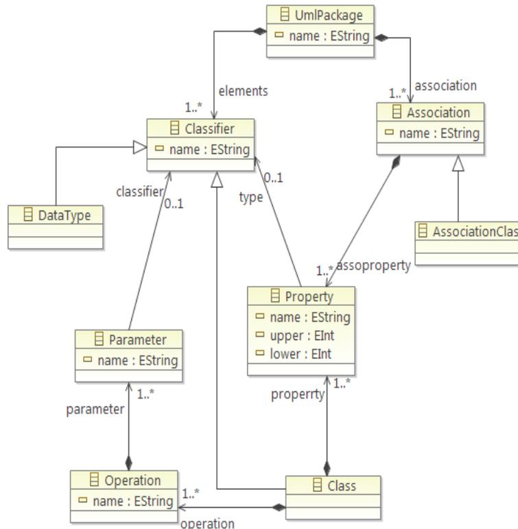
Fig. 3. Simplified UML Meta-Model
