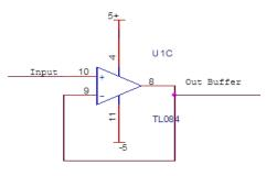
Fig. 9. Buffer Circuit
