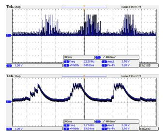
Fig. 21.Output of Rectifier and Envelope Circuits
