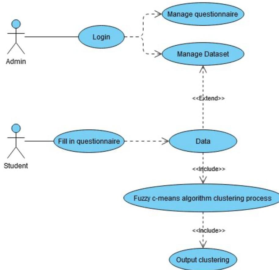
Fig. 3. Use Case Diagram
