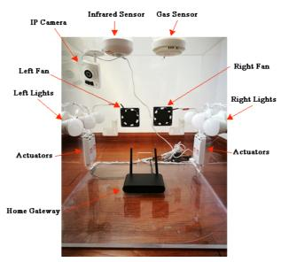
Fig. 10.System Prototype
